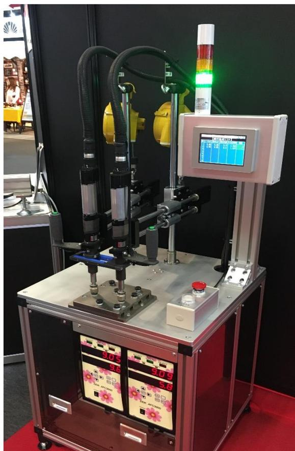
締結データ解析器 軸力モニタ付
