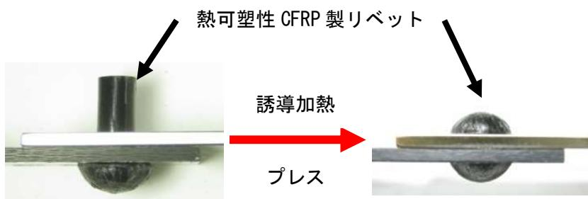
締結対象 : 热可塑性 CFRP + 金属 (鉄、AI、SUS 等)
