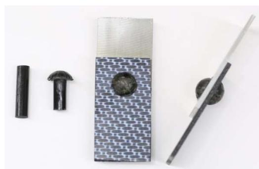
熱可塑性 CFRP 製リベットピンによる締結接合
