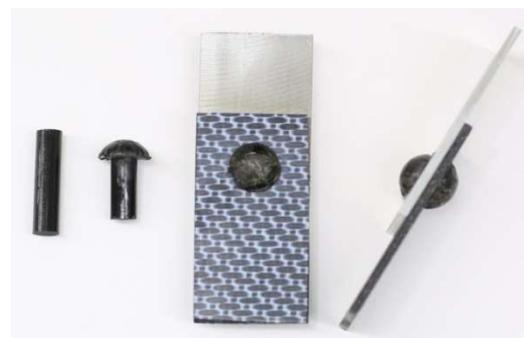
熱可塑性 CFRP 製リベットピンと
