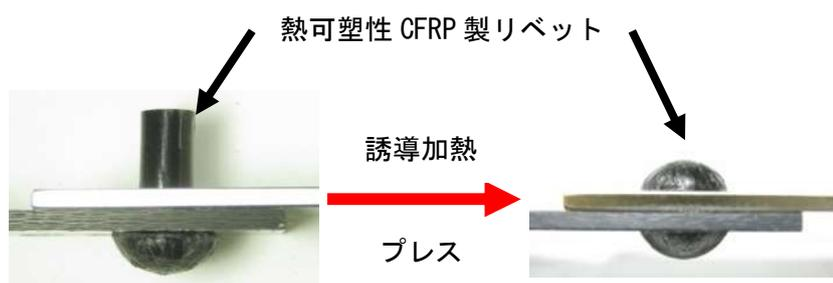
締結対象 : 熱可塑性 CFRP + 金属 (鉄、Al、SUS 等)
