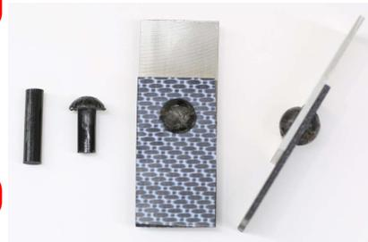
熱可塑性CFRP製リベットピンと異種素材の接合サンプル
