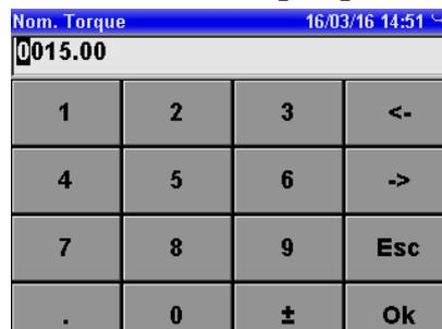
続けて、[Min Torque][Max Torque] (トルク上下限) を入力
