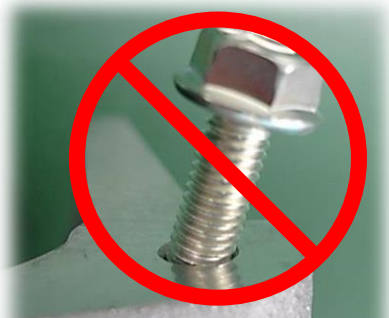
斜め入りによる 組付不良
